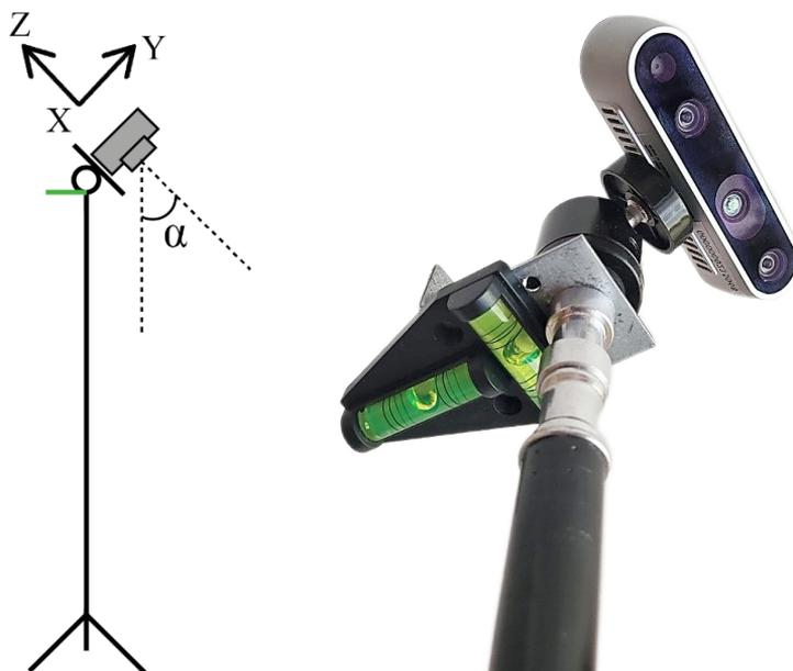
**Рис. 1.** Конструкция для съема трехмерных данных крупы коровы
