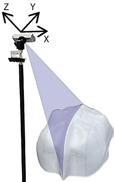
**Рис. 2.** Схематичное представление съемки макета коровы
