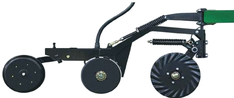
Рис. 1. Секция сеялки прямого посева с модулями для локального рыхления почвы и посева [5]
