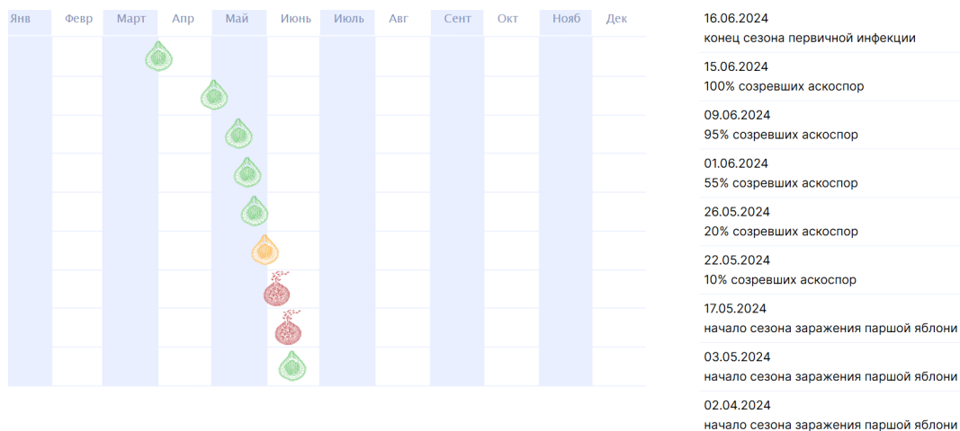
Рис. 3. Агромодель интеллектуальной платформы Agrokeeper, прогнозирующая созревание аскоспор Venturia inaequalis на основе данных локальной метеостанции в 2024 г. в яблоневом саду Солнечногорского района Московской области: зеленый цвет означает низкоинтенсивные периоды начала и конца развития сезона первичной инфекции, желтый цвет – созревание 50–55% аскоспор, красный цвет – созревание 95–100% аскоспор
